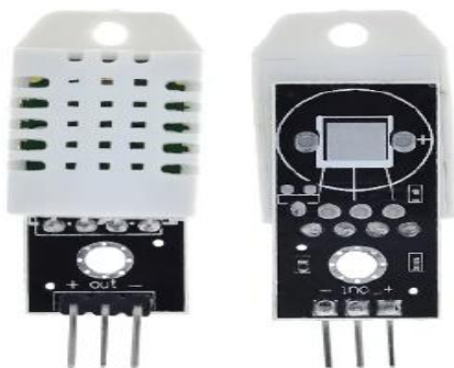
Figura 3. Sensor de temperatura y HR –DHT22 (AM2302).
