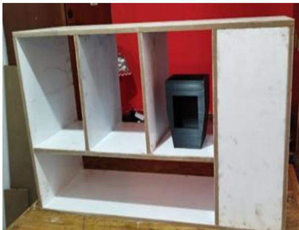
Al terminar el ensamble de la se ranura y perfora para colocar los accesorios que se requieren para una máquina vending; un display, botones y un contenedor multimonedas para el cobro del producto.
