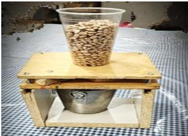
El prototipo de dosificador será automatizado con la ayuda de un servomotor y algunos microcontroladores, que permitirán simular el funcionamiento, con ello comenzarán las primeras pruebas.
