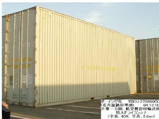
Figura 1. Contenedor marítimo tipo High Cube de 40 pies
