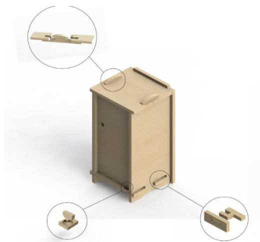
Figura 3. Modelado CAD y detalle del sistema espiga-caja y de la pieza llave
