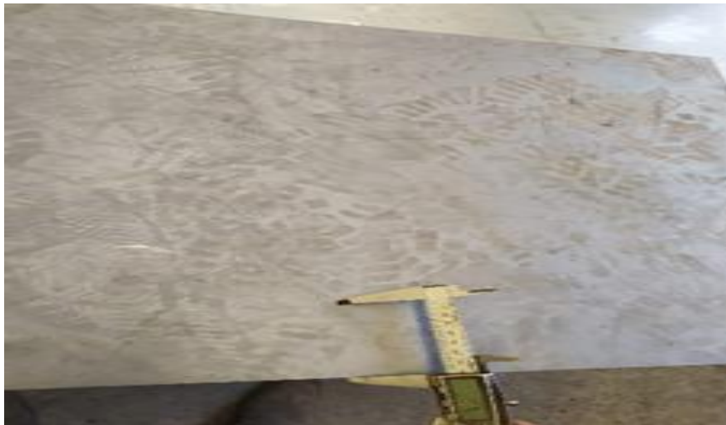
Figura 1. Medición para corte de lámina galvanizada calibre 28
