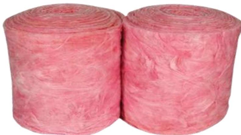
Figura 3. Fibra de vidrio utilizada en el proyecto
