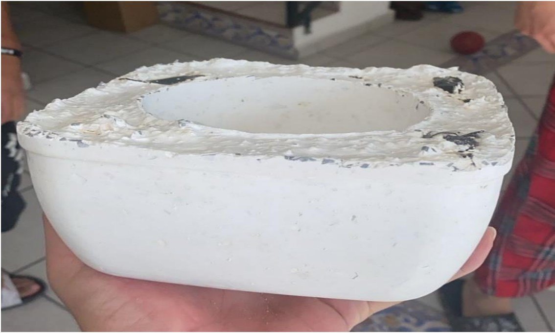
Figura 3. Macetas realizadas con la mezcla de cemento y caucho
