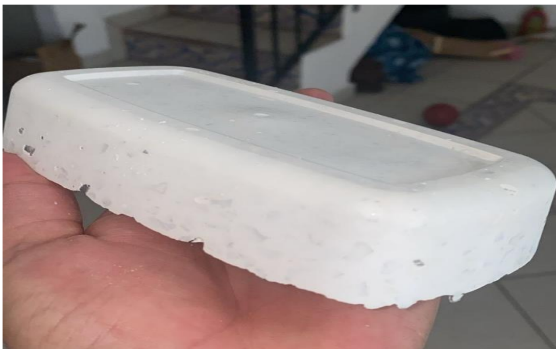
Figura 2. Ladrillos realizados usando la mezcla de cemento y caucho
