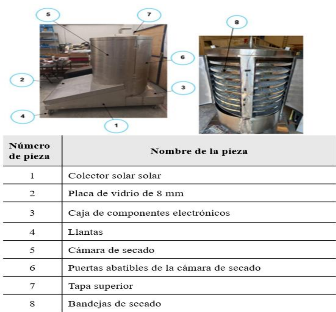
Figura 1. Deshidratador solar tipo cilindro (silo) de convección natural
